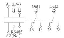
A1, A2:輸入電源AC/DC 100~240V I1, I2: 輸入信號AC/DC 100~240V
